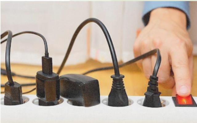
Este consumo se genera debido al funcionamiento de la fuente de alimentación de los aparatos prácticamente todos los dispositivos eléctricos y electrónicos llevan una fuente de alimentación o un adaptador que convierte la corriente alterna en continua. Después, la transforma a la intensidad y la tensión adecuadas para cada aparato.
